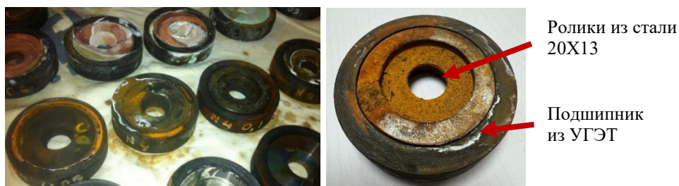
Рисунок 1 – Вид образцов пар трения (стальной ролик и подшипник скольжения из УГЭТ) после длительной выдержки в морской воде.
