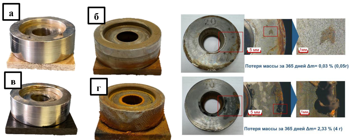
Рисунок 7 – Фотографии гальванической пары образец ПКМ – ролик из 20Х13: а) ПЭСТ и ролик до выдержки в воде; б) ПЭСТ и ролик после 90 дней выдержки в воде; в) УГЭТ и ролик до выдержки в воде; г) УГЭТ и ролик после 90 дней выдержки в воде
